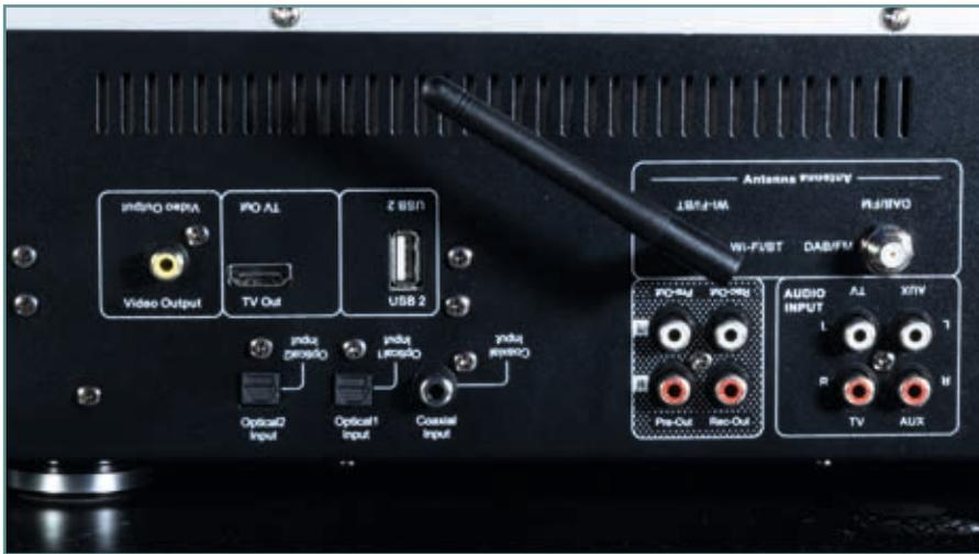
Die BB-200 bietet reichlich Eingangsquellen sowie Anschlüsse für den TV oder Beamer in Form von HDMI oder Video Output
